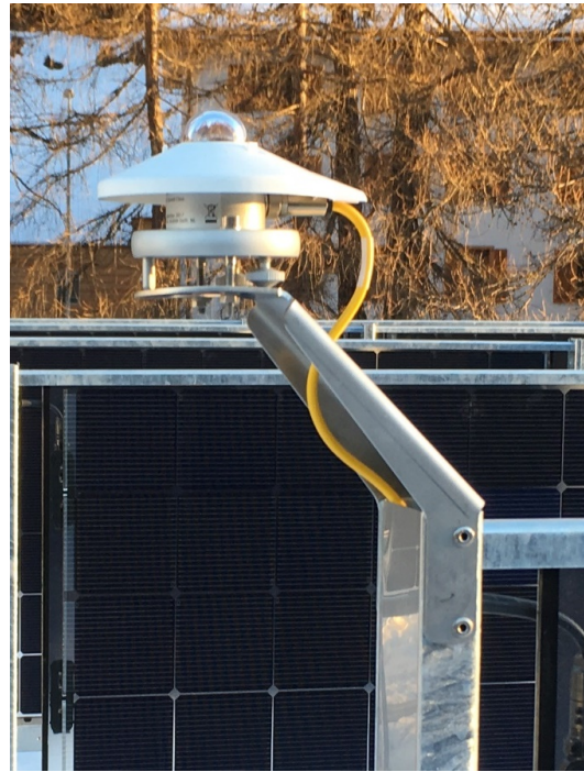
Abbildung 5: Ausgerichtete Si-Einstrahlungsmesser (links) und Pyranometer für globale Horizontalstrahlung
