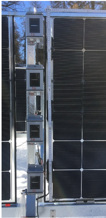
Abbildung 5: Ausgerichtete Si-Einstrahlungsmesser (links) und Pyranometer für globale Horizontalstrahlung
