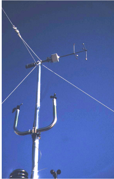
Mat météo placé sur la toiture du bâtiment 6-7. Un anémomètre ultrasonique à trois dimensions est placé à 2.5 m du toit. La vitesse du vent est mesurée avec deux anémomètres à coupelles placés à 2 m et à 1 m au dessus des capteurs. La température et l'humidité de l'air sont également obtenues.
