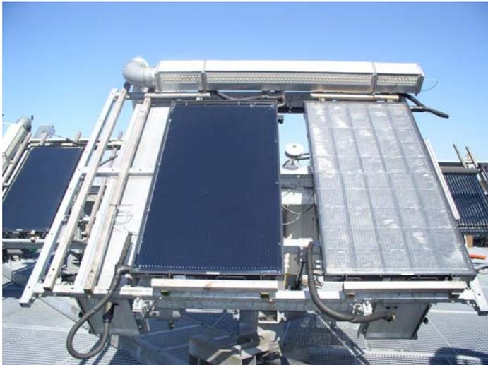
Figur 2: Vergleichsmessung eines Kollektors mit zusätzlicher Teflonfolie.
