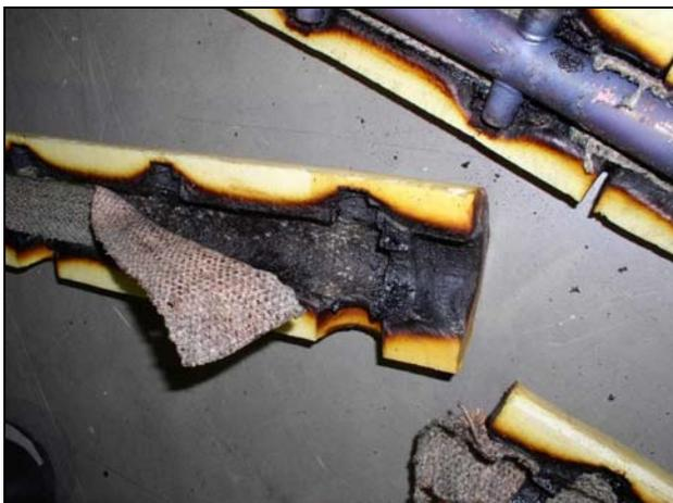
Figur 1: Isolation eines Röhrenkollektors nach Hochtemperatur Beständigkeitsprüfung
