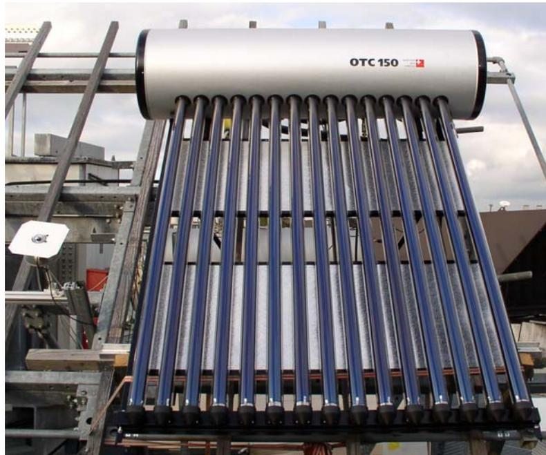
Fig. 2: Die Leistungsdaten des Systems wurden am SPF nach europäischer Norm ermittelt. Der Kollektor des abgebildeten Thermosiphonsystems besteht aus 15 Vakuumröhren mit Heat-Pipes, die in den Solartank (150 l) reichen und dort die Solarenergie übertragen. Die Wärmeübertragung führt zu einem vereinfachten Anlagenkonzept ohne Kollektorkreisleitung und einem einfachen Solarspeicher. Das Konzept hat damit ein vielversprechendes Potential bezüglich Kostenreduktion. (Quelle: SPF)
