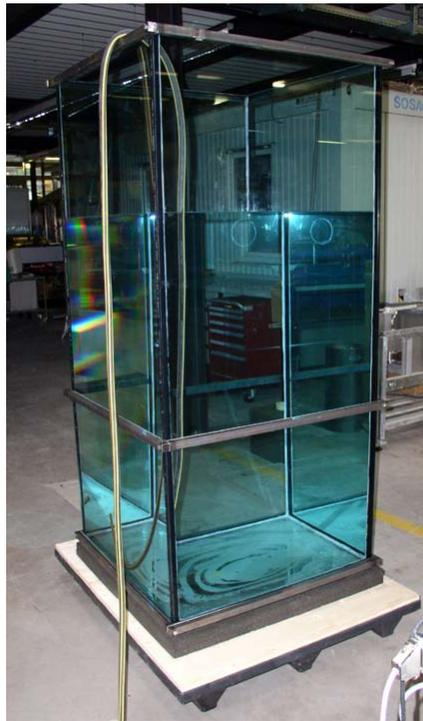
Fig. 4: Der abgebildete Glasspeicher hat bei einer Grundfläche von 800 mm mal 800 mm und einer Höhe von 1800 mm ein Volumen von ca. 1.15 m<sup>3</sup>. (Quelle: SPF)
