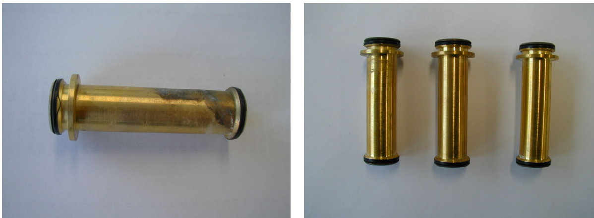
Fig. 3: Mangelhaft bearbeitete Kanten zerstören den O-Ring (links). Durch Änderung der Kanten konnte die Standzeit deutlich erhöht werden.
