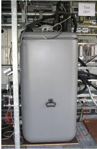
Fig. 2: Druckloser Kunststoffspeicher mit verbessertem Warmwasser-Wärmetauscher. Der optimierte Speicher wird im Teststand auf seine Leistungsfähigkeit geprüft.
