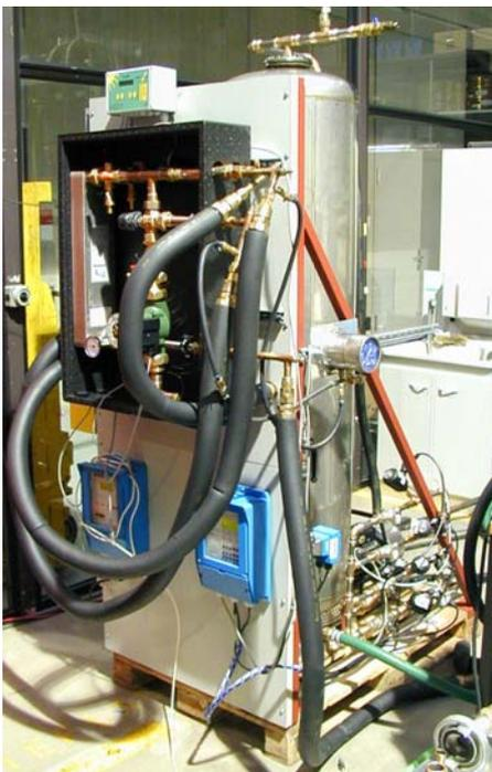
Fig. 6: Neuer Prüfstand für Frischwassermodule. Er erlaubt die quantitative und qualitative Untersuchung ganzer Frischwassermodule inklusive Regelung. Der Prüfstand wird ein standardisiertes Prüfprogramm mit verschiedenen primärseitigen Eingangstemperaturen und dynamisch variierenden Entnahmedurchflüssen automatisch abwickeln.
