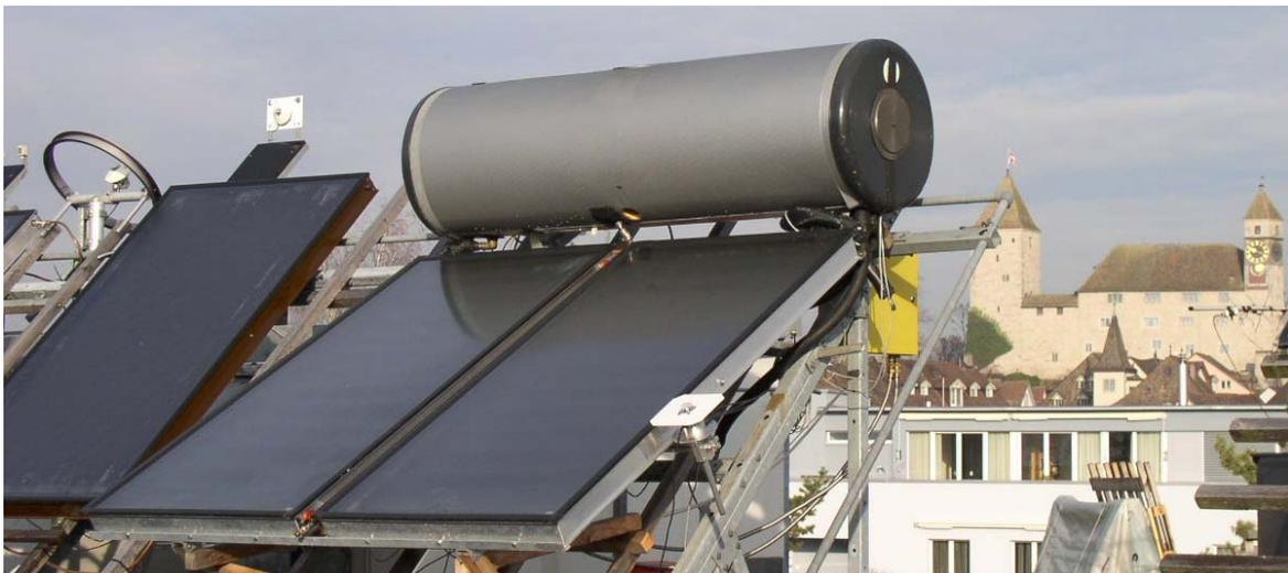
Fig. 1: Prototyp eines Thermosiphonsystems. Das System weist eine innovative Vorrichtung zum Schutz vor Überhitzung auf. In Prüfung am SPF 2003 (und 2004).
