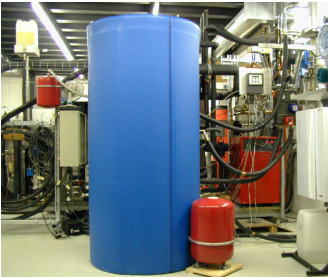
Abb. 2: Testanlage für Kombisysteme
