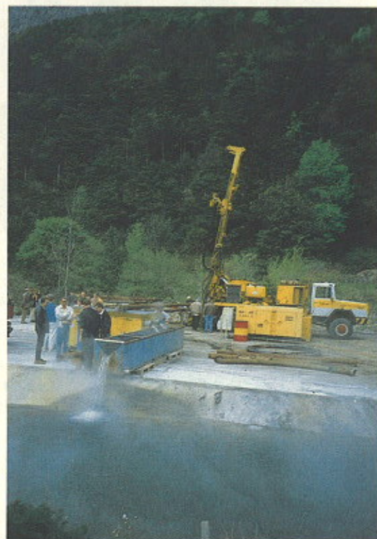
Essai de pompage de longue durée du sondage profond de Lavey-les-Bains
