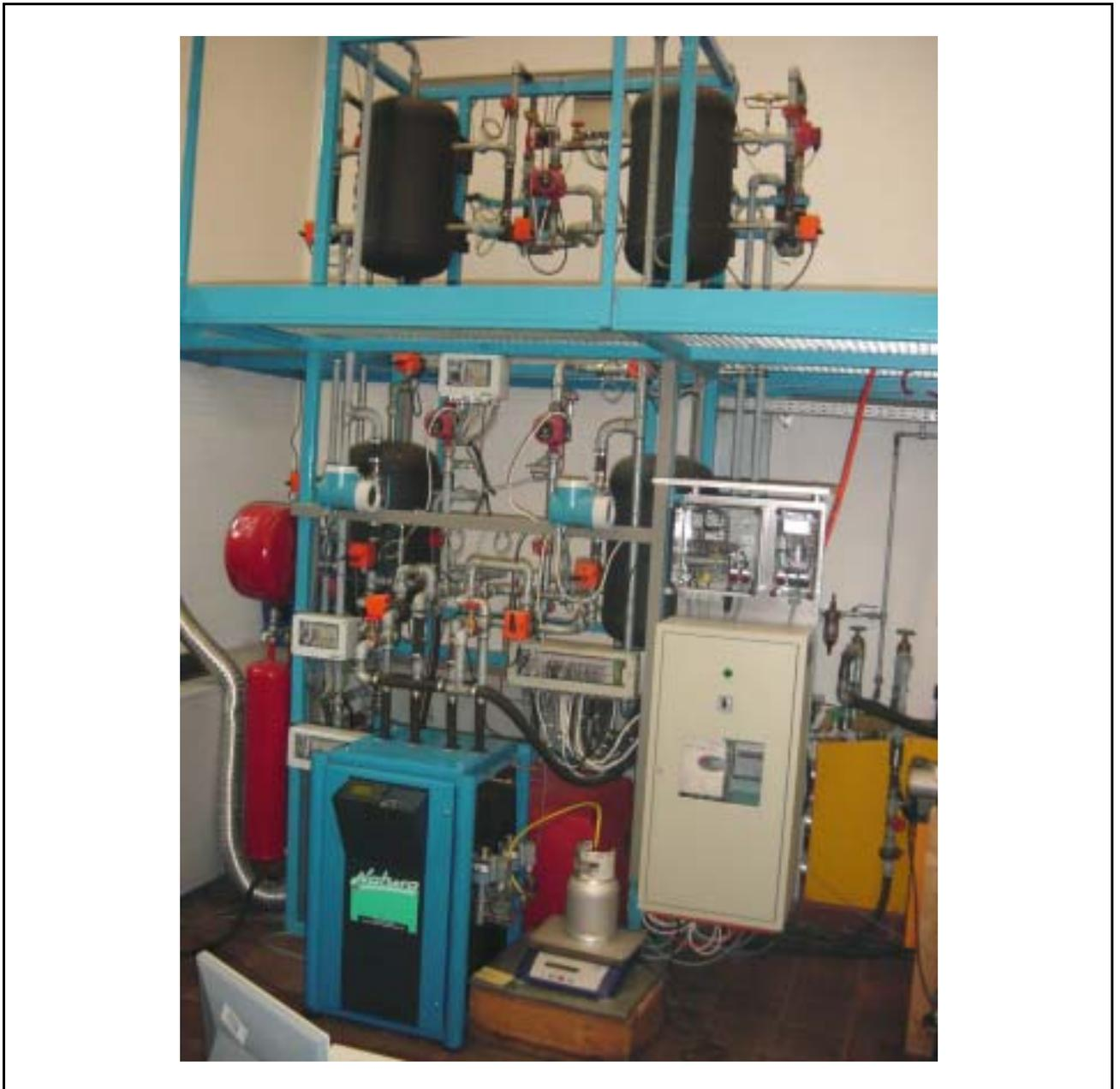
Abbildung 3: Der dynamische Sole/Wasser-Wärmepumpenprüfstand des Instituts für Mess- und Regeltechnik der ETH Zürich
