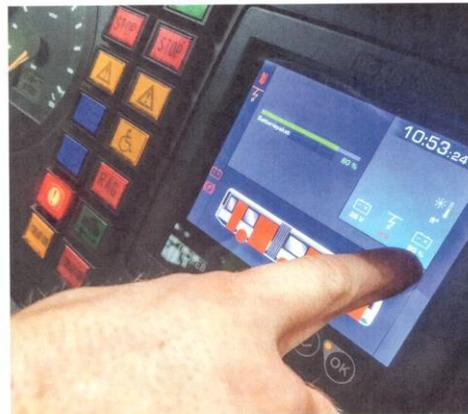
Für Busfahrer (im Bild links: VBZ-Chauffeur Fatmir Alijaj) bringt der Swiss Trolley plus nur geringe Umstellungen mit sich. Eine davon ist das programmierfähige Fahrpedal, das eine energiesparende Fahrweise begünstigt. Um die Batterie zu schonen, wird ein Ladestand zwischen 50 und 85 Prozent angestrebt (rechts).
