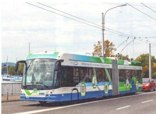
Die Batterie des Swiss Trolley plus wird während des Fahrens geladen, wenn eine Oberleitung zur Verfügung steht.
