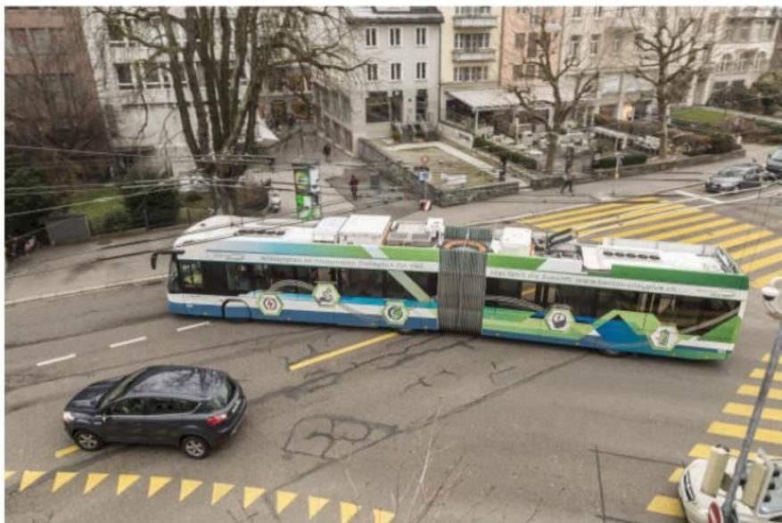
Der neuartige Hybrid-Trolleybus bezieht den Fahrstrom entweder über die Oberleitung oder über eingebaute Batterien. Eines dieser Fahrzeuge ist derzeit auf Testfahrt in St.Gallen - im Bild auf der Verzweigung Oberer Graben/Poststrasse. (Bild: Hanspeter Schiess)
