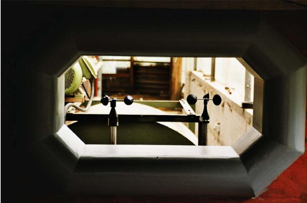
**Abbildung 3 Windkanal Ausströmöffnung**
