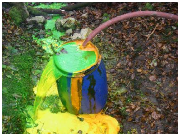
Figure 27 Essai de traçage mené en mars 2011 à la décharge des Frêtes (NE) dans le cadre des investigations techniques OSites : photographies du colorant injecté (gauche) et de sa restitution à la source sous-lacustre des Bains dans la rivière du Doubs, 2 jours après l'injection. D'après (MFR, 2011).
