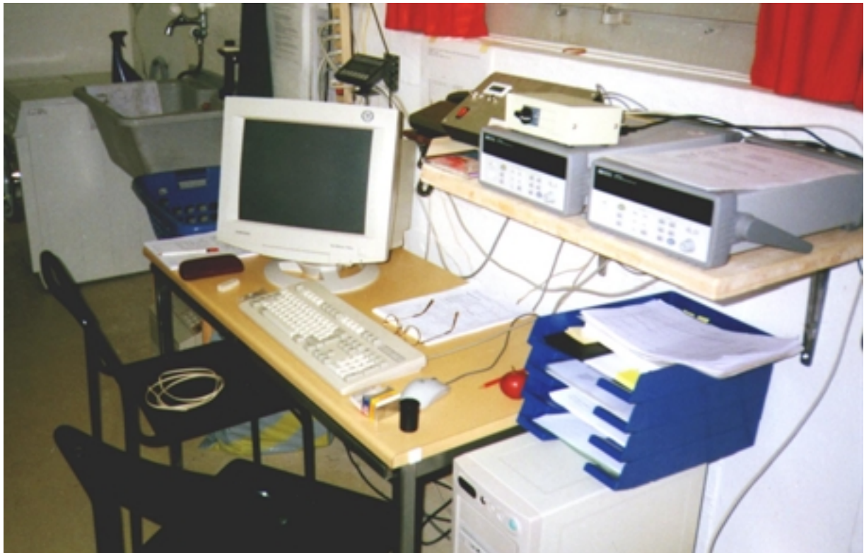
Bild 3 Mess-Arbeitsplatz mit Dataloggern, Switchbox, Steuerpult, PC, im Hintergrund Waage-Display, Waschtrog und Waschmaschine.
