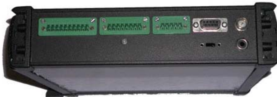
Fig 3: Anschlüsse der SMS, alle als Stecker ausgeführt. 5 Digital In, 4 Digital Out, 2 Analog In, Antenne und Stromversorgung, RS232 zur Konfiguration
