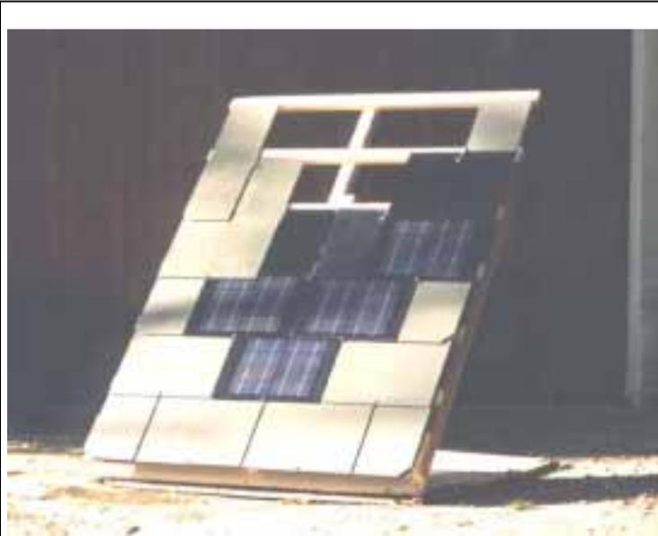
Bild 2 zeigt den Versuchsaufbau mit den neuen Solarschieferplatten. An diesem Demostand wurden alle dachspezifischen Fragen mit Dachdeckern erörtert. Insbesondere wurden auch die verschiedenen Verkabelungs-Varianten durchgespielt, und die Austauschbarkeit der Module am Teststand geübt. Damit wurden wertvolle Erfahrungen gewonnen. Diese wurden in einer erweiterten Prototypenserie integriert, und in einer richtigen Dachsituation auf einem Haus nochmals verifiziert.
