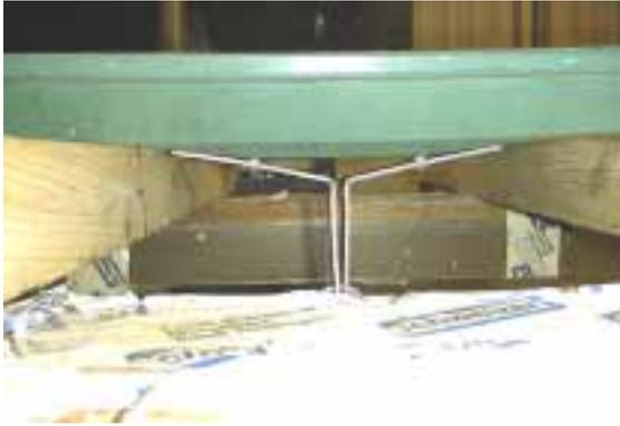
Im Dezember 2000 wurde bei der Firma Ernst Schweizer AG ein Zugversuch an der Verankerung durchgeführt. Das Bild 21 zeigt die enorme Belastung bei 240 kg, die auf nur zwei Niete (Durchmesser 6 mm) eingeführt wird. Die Verbindung erfüllt jegliche Anforderungen und wird bei der Weiterentwicklung der Konstruktion als Basis verwendet, wie auch die Grundplatte aus Deltatec®.
