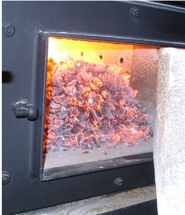
Bild 7: Feuerraum mit Glutbett bei einem Glutbettluftüberschuss von knapp 0,3. Fast der gesamte Feuerraum ist gefüllt mit glühenden Schnitzeln.
