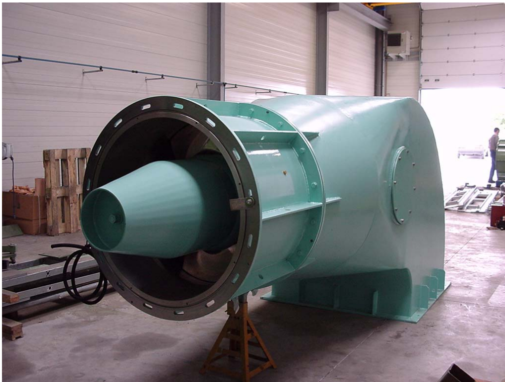
Vue de la turbine des Farettes pré-montée en atelier (vue depuis l'aval roue)
