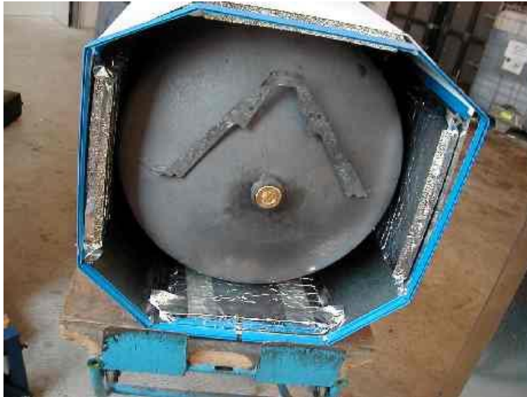
Abb. 22: Einbauwassererwärmer mit Instill-VIP, Ansicht von oben vor dem Einbringen des PU-Schaums. An den seitlichen Wänden sind die VIP sichtbar.
