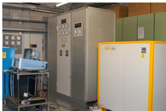
Figure 6 : Générateur simulateur solaire de 100 kW avec un onduleur Sputnik de 100 kW (Source: HESB-TI)
