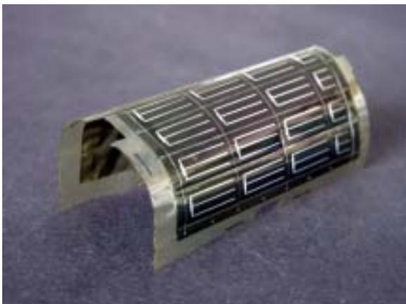
Figure 3: Cellule solaire flexible CIGS sur feuille polyimide (Photo EPFZ)
