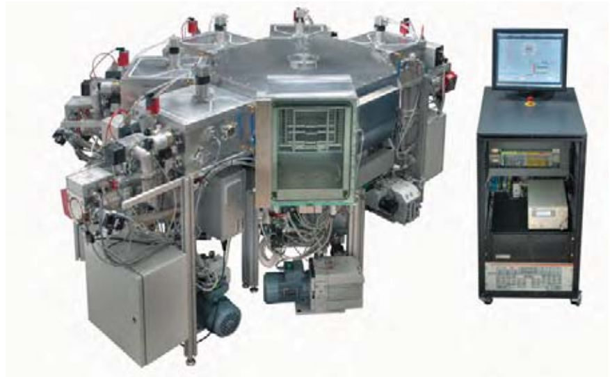
Figur 1: Neue PECVD Cluster-Depositionsanlage OCTOPUS am PV-Lab der EPFL (Bild PV-Lab).
