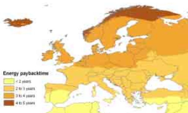
Figur 9: Energierücklaufzeit einer 3 kW multikristallinen Schrägdachanlage in Europa (Basis UCTE Mix) (Bildquelle: ESU Services)
