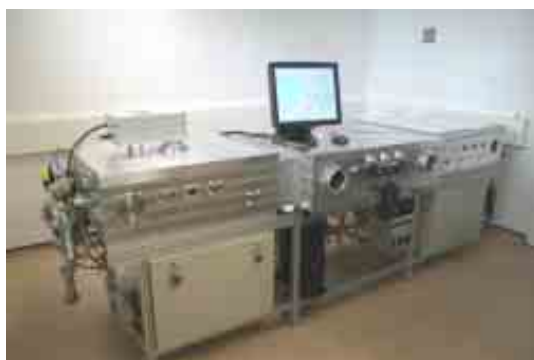
Figur 1: Automatisiertes Dünnschichtsilizium-Doppelkammer-Depositionssystem auf der Grundlage der KAI-M plasma box von oerlikon (Bildquelle: IMT)
