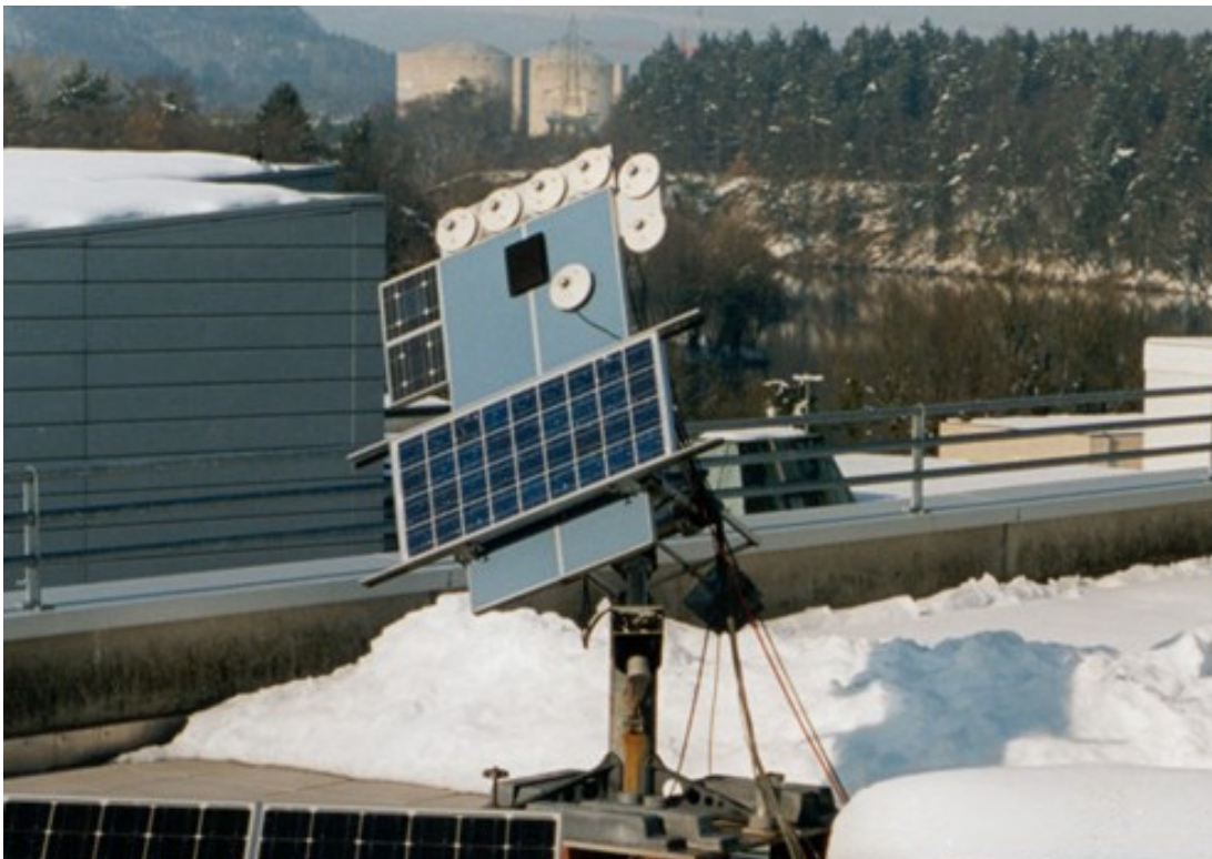
Abb. 1: Freiland-Testanlage des PSI zur Messung des Wirkungsgrades von Modulen. Die zu testenden Module werden auf einem Sun tracker befestigt. Während einer Wirkungsgrad-Messreihe richtet der Tracker die Testmodule kontinuierlich zur Sonne aus. Zur genauen Messung der Einstrahlung auf die Module dienen Pyranometer und Referenzzellen (oben am Sun tracker montiert). Die Signale werden ins nahe gelegene Labor geleitet, wo sie gemessen, verarbeitet und gespeichert werden.
