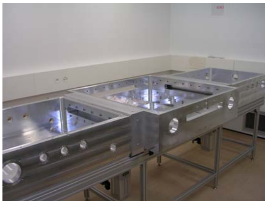
Figur 1 Aufbau des Dünnschichtsilizium-Doppelkammer-Depositionssystems auf der Grundlage der KAI-M plasma box von oerlikon (Bildquelle: IMT)
