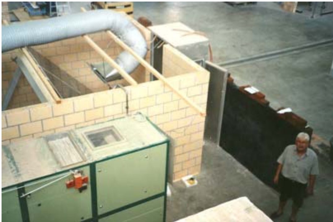
Abbildung 4: Prüfraum für die Regensicherheit
