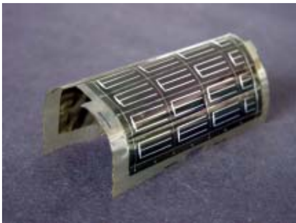
Figur 3: Flexible CIGS Solar Zelle auf Polyimid Folie (Bildquelle ETHZ)
