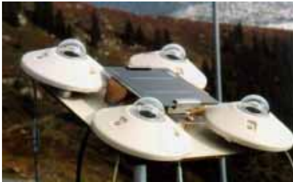
Fig. 1: Anordnung von 4 Pyranometern (Kipp & Zonen CM11) sowie einer Silizium-Referenzzelle (ESTI) während einer Kalibrierung am 18. September 1996 in Disentis-Caischavedra
