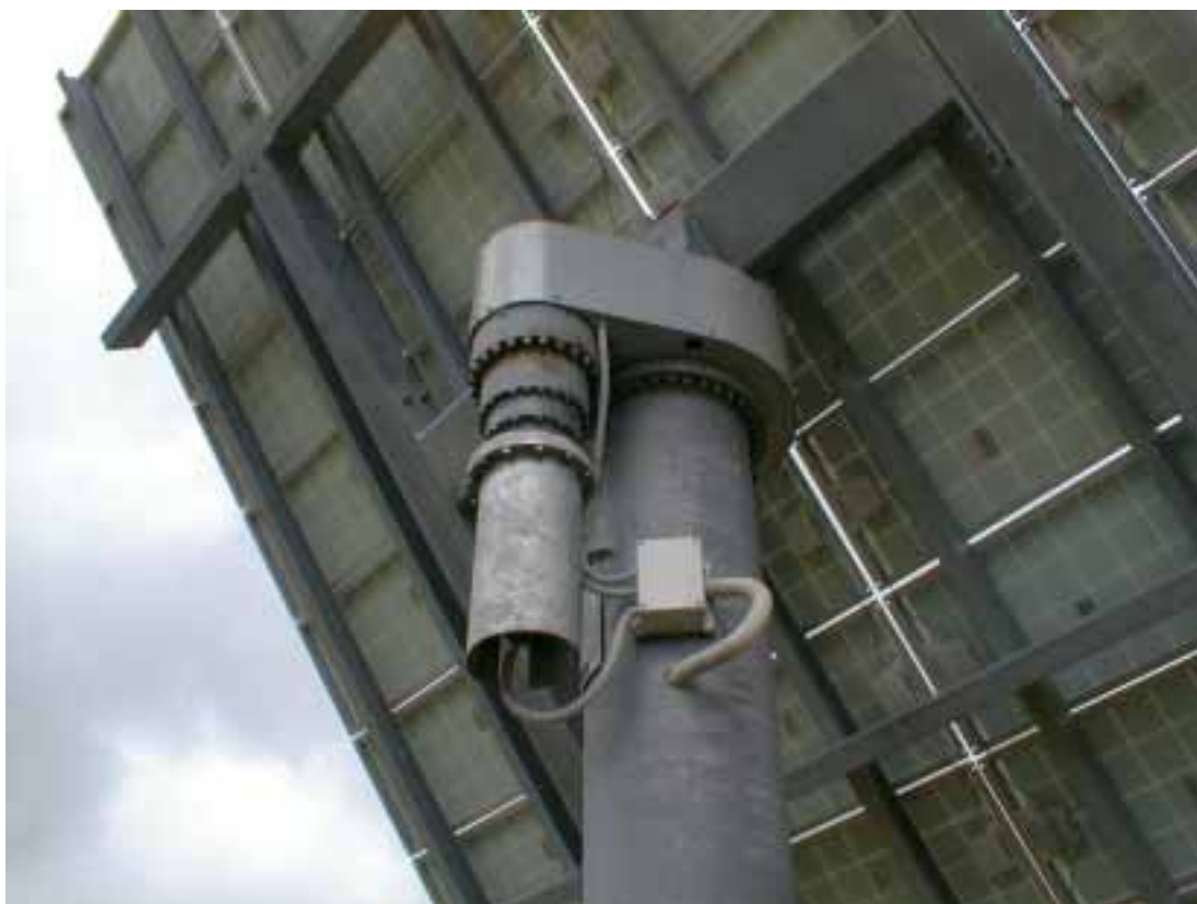
Figure 5: Dispositif d'orientation de l'arbre mobile
