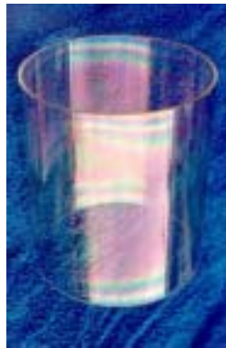
Abb. 2: IR reflektierendes \text{SnO}_2 Filter von Solaronix, das auf der Innenseite eines Quarzzylinders abgeschieden wurde.
