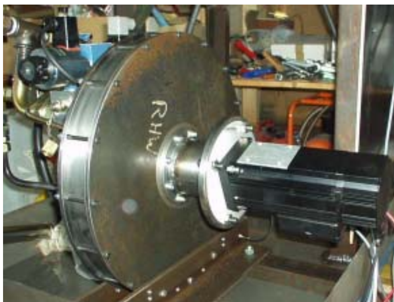
Photo 2 : ensemble générateur depuis air comprimé sur banc d'essai, détails du volant d'inertie et de la génératrice électrique.
