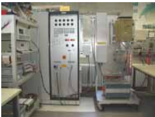
Bild 5: PV-Generator-Simulator 25 kW (HTA Burgdorf), (Bildquelle: HTA Burgdorf)
