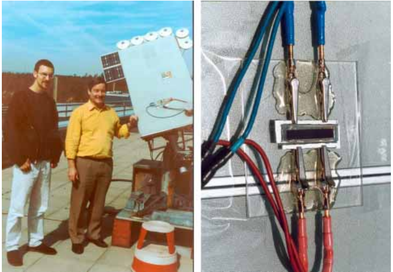
Abbildung 1. Teststand auf dem Dach des PSI zur Aussenmessung von Farbstoff-Solarzellen. Links: Carl Haegglund (EPFL) mit Dr. Durisch (PSI). Rechts: Farbstoffzelle.
