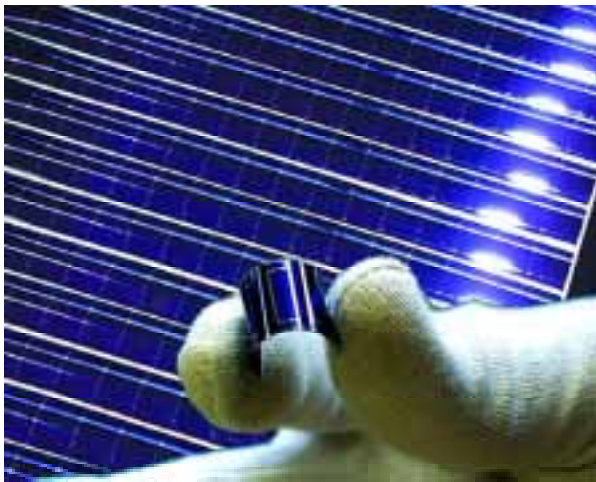
Figure 6 : Cellules solaires pour une application carte-à-puce structurées et mises-en-série par procédé « lift-off »
