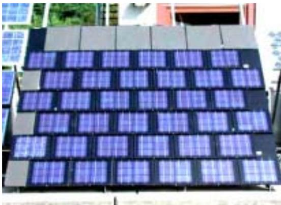
**Bild 20:** Teststand mit Sunplicity Dachziefern
