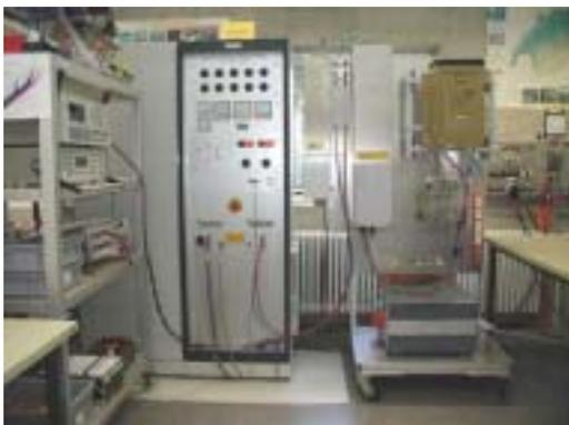
**Bild 5:** PV-Generator-Simulator 25 kW (HTA Burgdorf),
