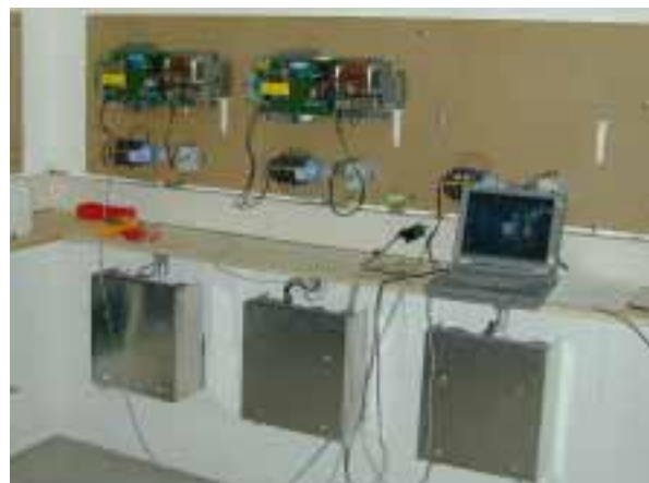
Bild 5: Wechselrichterprototyp mit LON Knoten, Foto: NET AG
