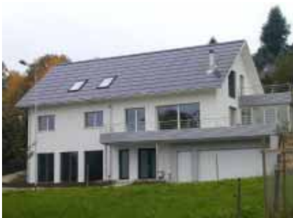
Bild 4: Dachintegration mit SOLRIF Foto: Enecolo AG
