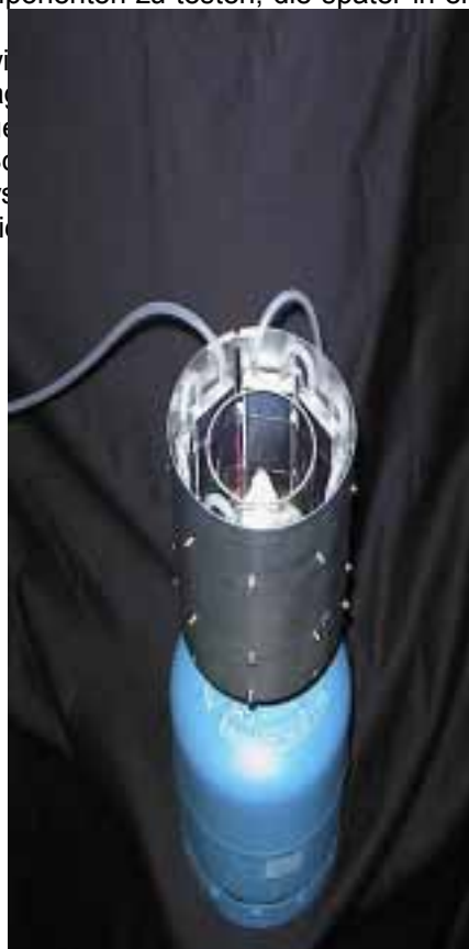
Abb. 8: Aktuelles TPV Kleinsystem. Zum Schutz vor konvektiver Erwärmung durch die heissen Rauchgase dient ein Quarzglasrohr. Mit diesem System konnte der Weltrekord-Wirkungsgrad eines TPV-Systems erreicht werden.
