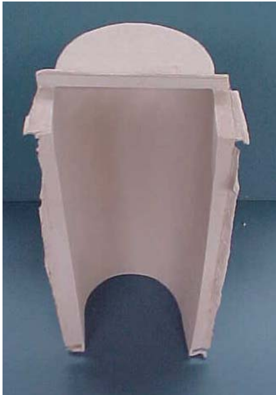
Abb. 3. Der Brennraumprototyp aus Keramikblech für T.one. Hohe Herstellungskosten und unreifes Herstellungsverfahren haben Tonwerk Lausen AG veranlasst, den gegossenen Brennraum für den T.one zu wählen.
