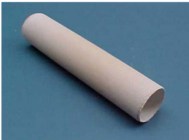
Abb.1. Ein Rohr aus Keramikblech. Wandstärke 2 mm.
