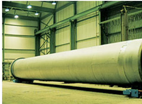
ABBILDUNG 9.9 Figur 9: Pyrolyserohr für die Technip-Pyrolyseanlage Hamm aus Nicrofer 3220 H - alloy 800 H (material no. 1.4876, UNS N08810), Werksbild Krupp VDM.
