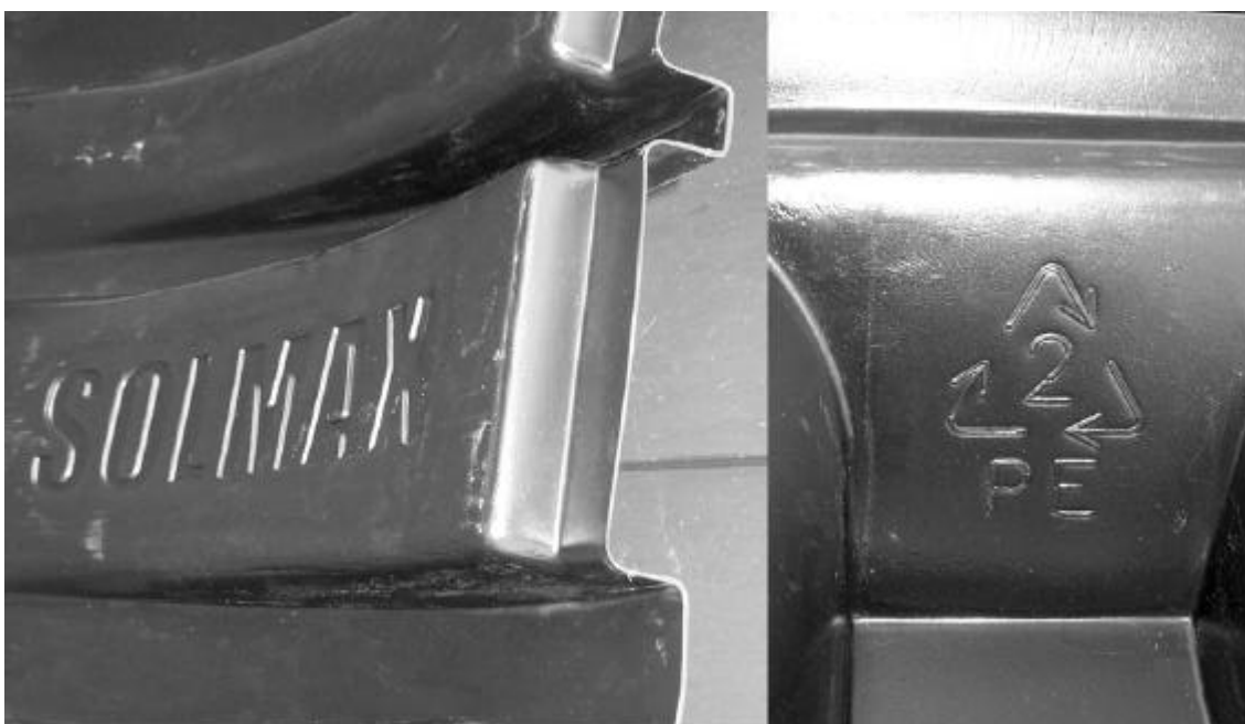
Fig. 3: SolMax est réalisé par thermoformage de polyéthylène haute densité (PE-HD). Ce matériau est à la fois recyclé et recyclable. Le polyéthylène utilisé est d'un poids moléculaire assez bas ce qui lui confère une grande souplesse et une excellente tenue mécanique. Ce matériau est particulièrement résistant au rayonnement ultra-violet et aux variations de température.
