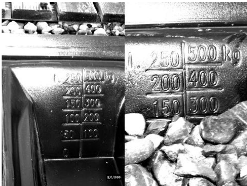
Fig. 1: Solmax est doté d'une jauge indiquant la quantité de gravier contenue (indiquée en litres et en kilogrammes).
