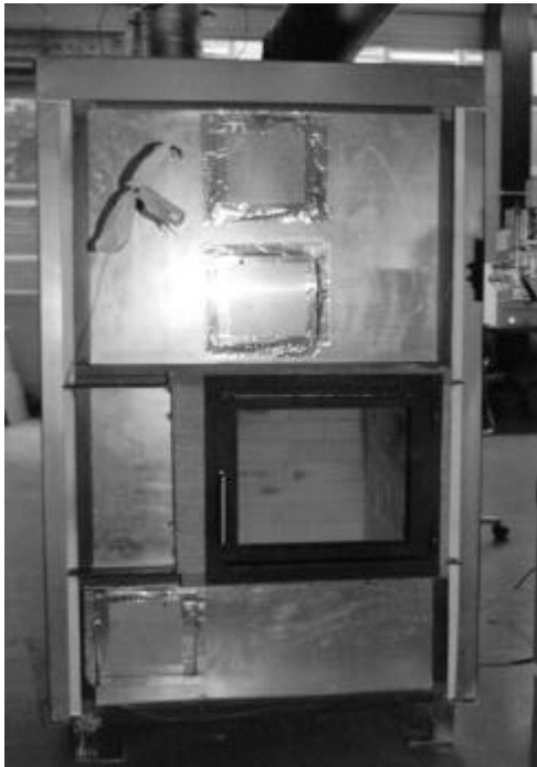
Figur 3.4 / 3.5: Luftregister mit Stahlblech-Aussenmantel
