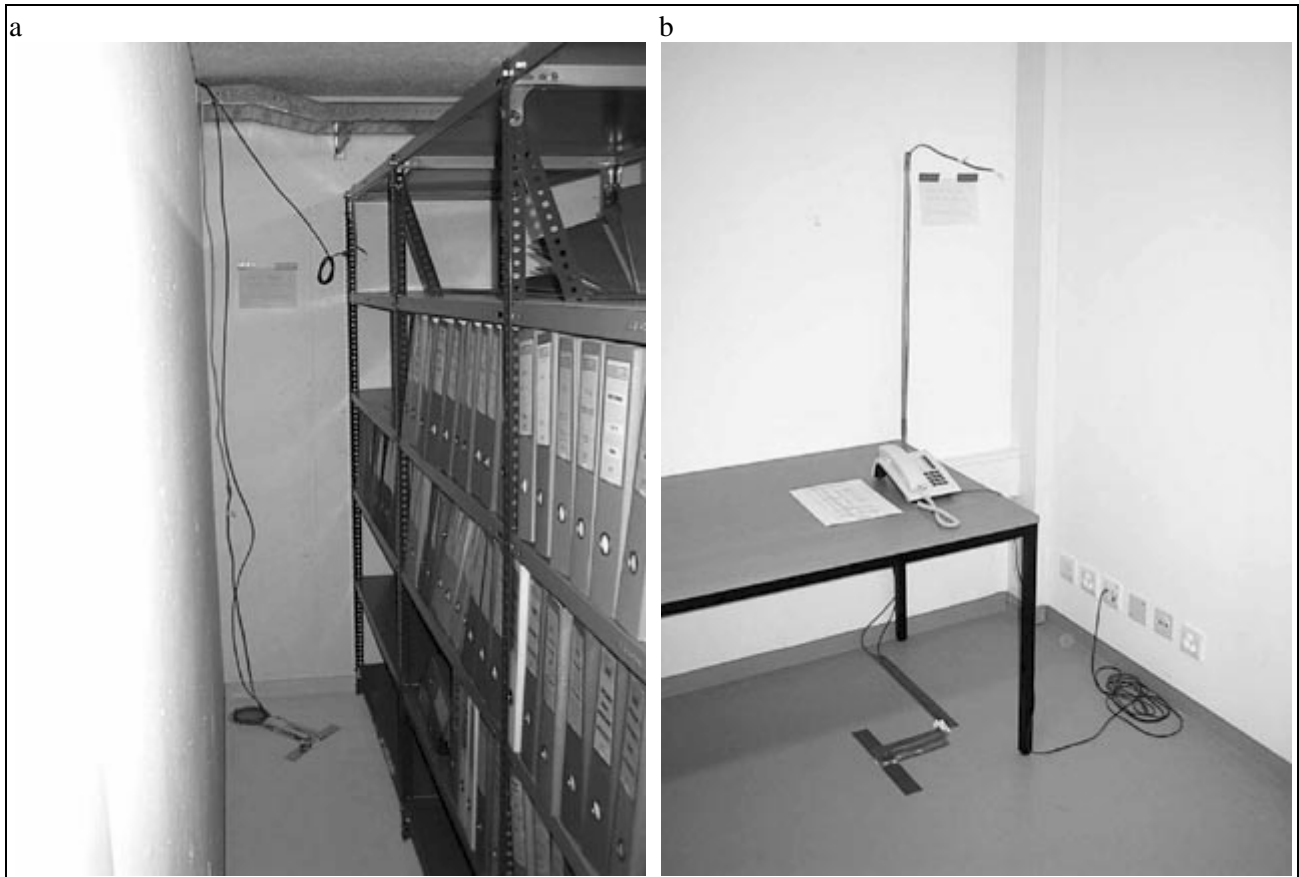
Fig. 6 : Mesure locale du flux de chaleur bâtiment/sous-sol : a) local archives ; b) salle de conférence.
