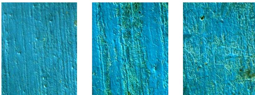
Abb.26: Martensitverteilung im Längsschnitt bei 15.71 vol.-% Martensit (30 °C)
