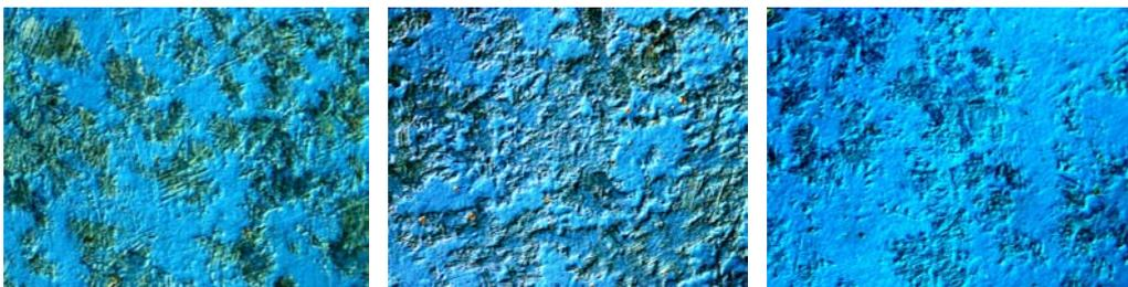
Abb.24: Martensitverteilung im Querschnitt bei 15.71 vol.-% Martensit (30 °C)
