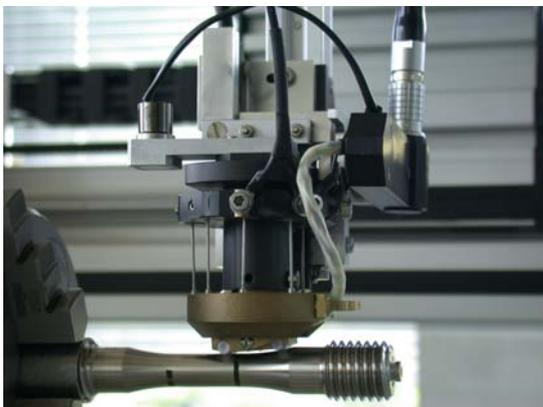
Abb. 47: Wirbelstromimpedanz- Messplatz mit Manipulator und GMR-Sensor
