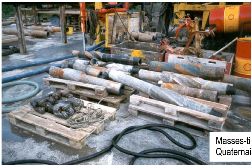
Tricônes pour perforation au rotary
