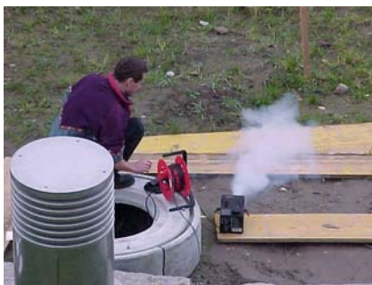
Bild 8-1 Dieses Bild zeigt die Rauchmaschine und den Ansaug, in den sie gelassen wird.
