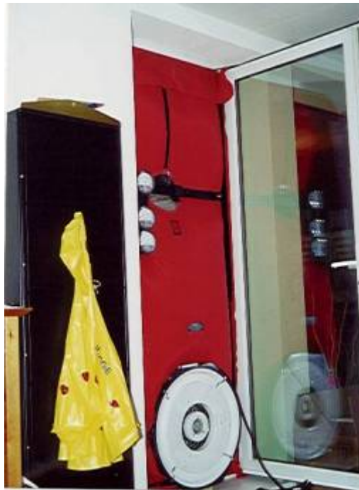
Bild 4-3 Blower-Door-Messung. Durch das Blower-Door-System wird in der Wohnung ein Unterdruck erzeugt, was ein vermehrtes Nachströmen durch Gebäuderitzen und undichte Stellen zur Folge hat. (I&T Bauphysik)
