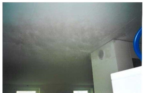
Bild 8-2 Deutlich zu erkennen ist, wie der Rauch aus den Warmluftdurchlässen strömt und sich entlang der Decke verteilt.
