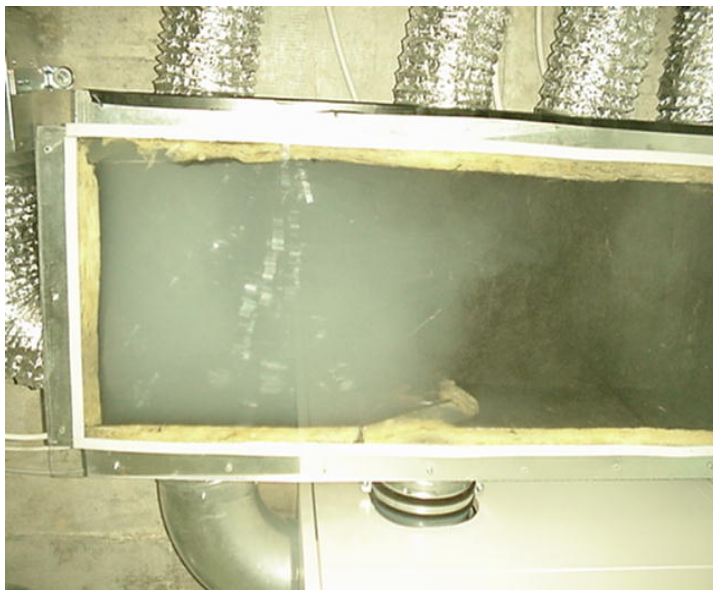
Bild 7-1 Rauchversuch mit Umluftbeimischung in Zuluftbox (Umluft links oben, Zuluft ab Lüftungsgerät unten)
