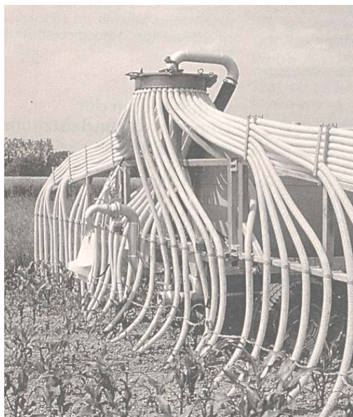
Foto 6: Schleppschlauchverfahren im Acker- und Futterbau. Die Gülle kann ab Druckfass oder über einen Schlauch ab fester Gülleverrohrung bezogen werden. (Bildquelle: Frick et al., 1997)
