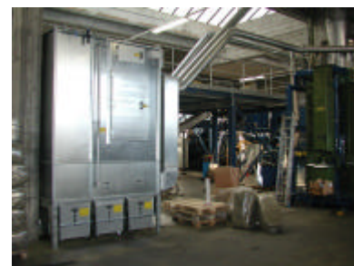
Bild Nr. 19 Absackanlage mit Staubmanagement
