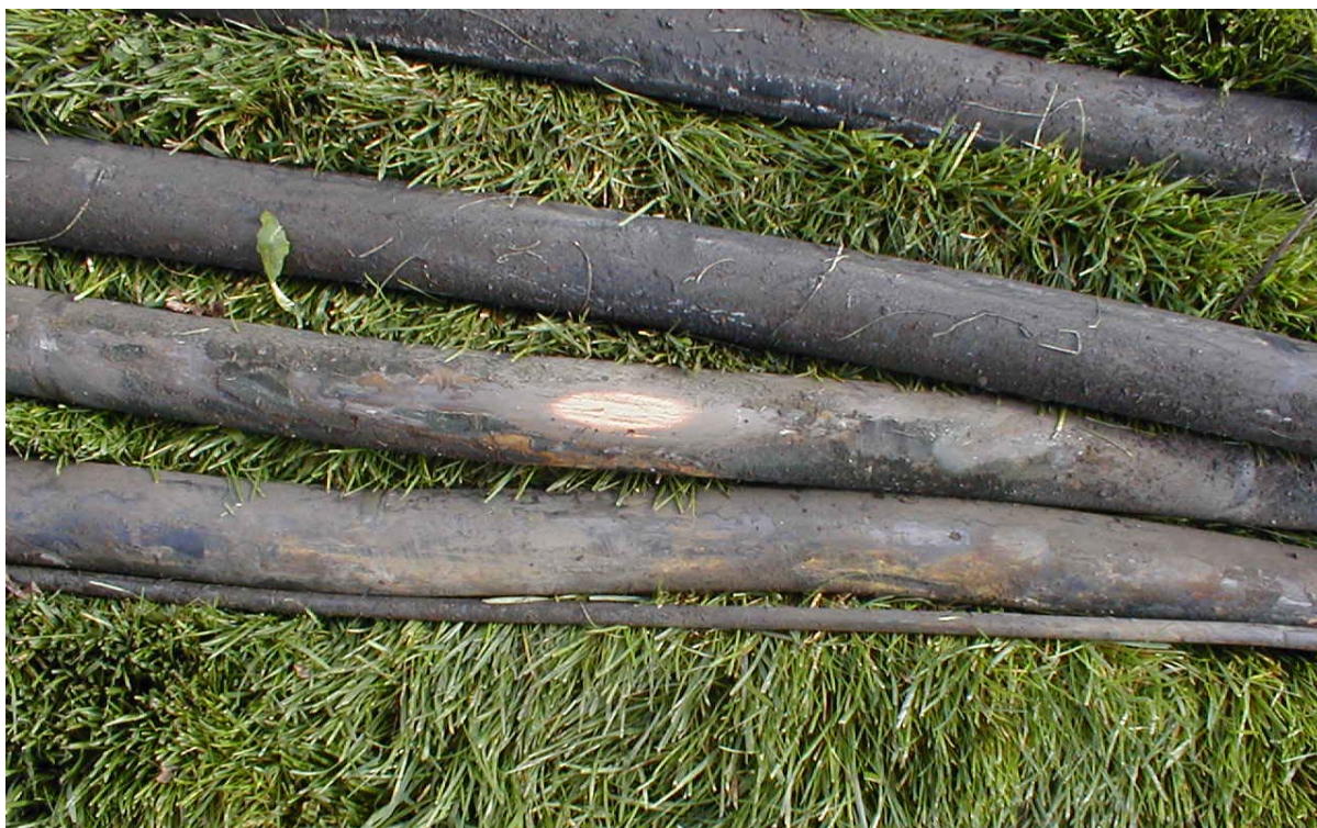
PHOTO 8 : Câbles électriques ressortis après la panne des pompes immergées (octobre 2002).
