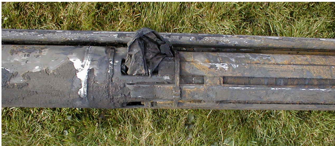
PHOTO 12 : Détail de l'aspiration bouchée de la pompe immergée N° 1 (octobre 2002).
