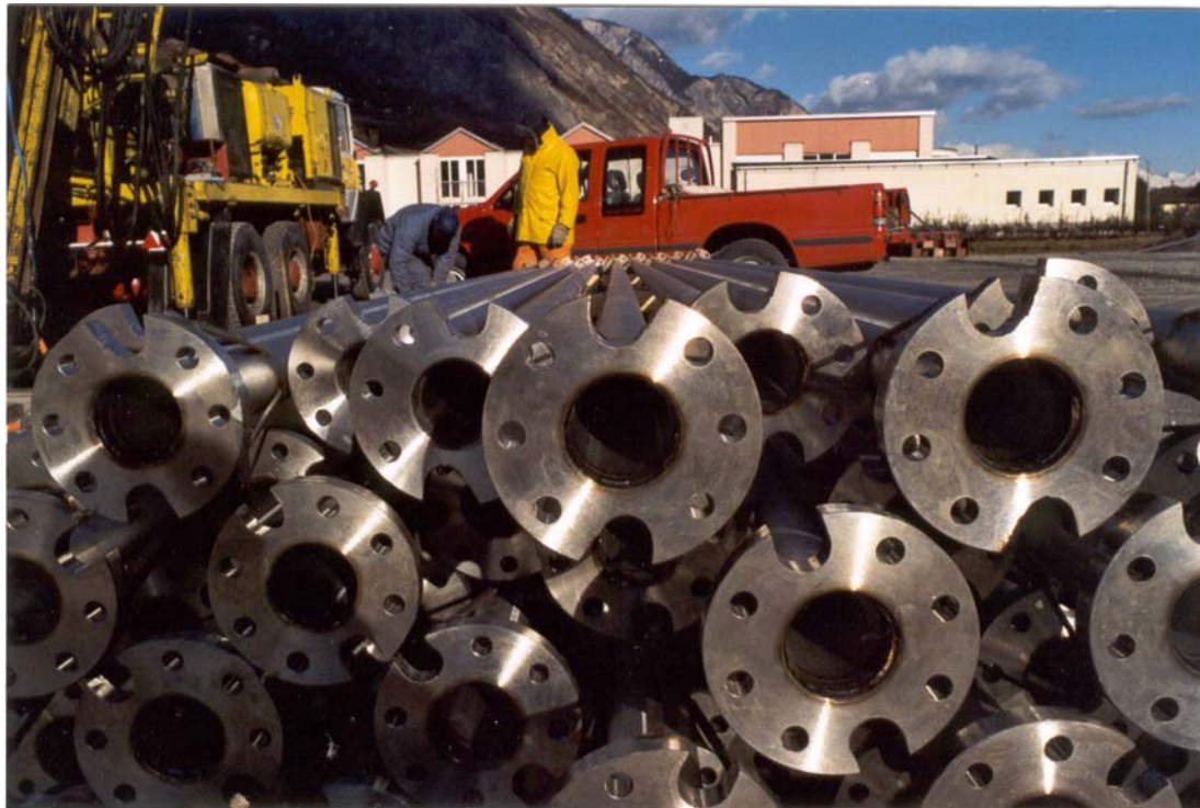
PHOTO 3 : Colonne de pompage en INOX et raccords à bride (avril 1999).
