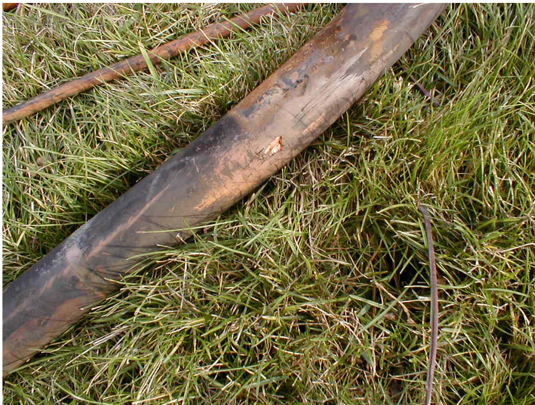
PHOTO 10 : Détail d'un câble électrique SEIC écrasé et "blessé" (octobre 2002).
