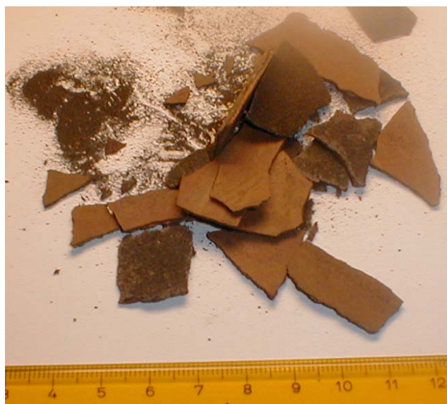
PHOTO 14 : Détail des encroûtements de sulfures de fer qui recouvraient les pompes et la colonne de pompage (épaisseur : 1 à 2 mm).
