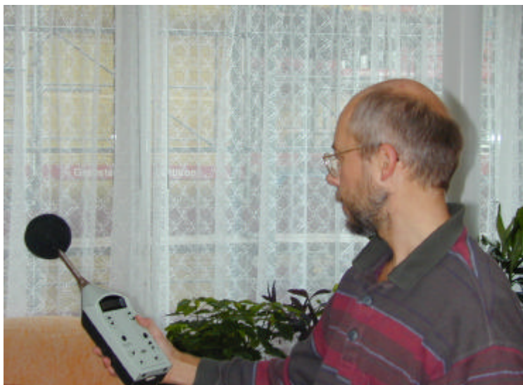
Abbildung 3.3 Lärmmessung in einem Wohnzimmer
