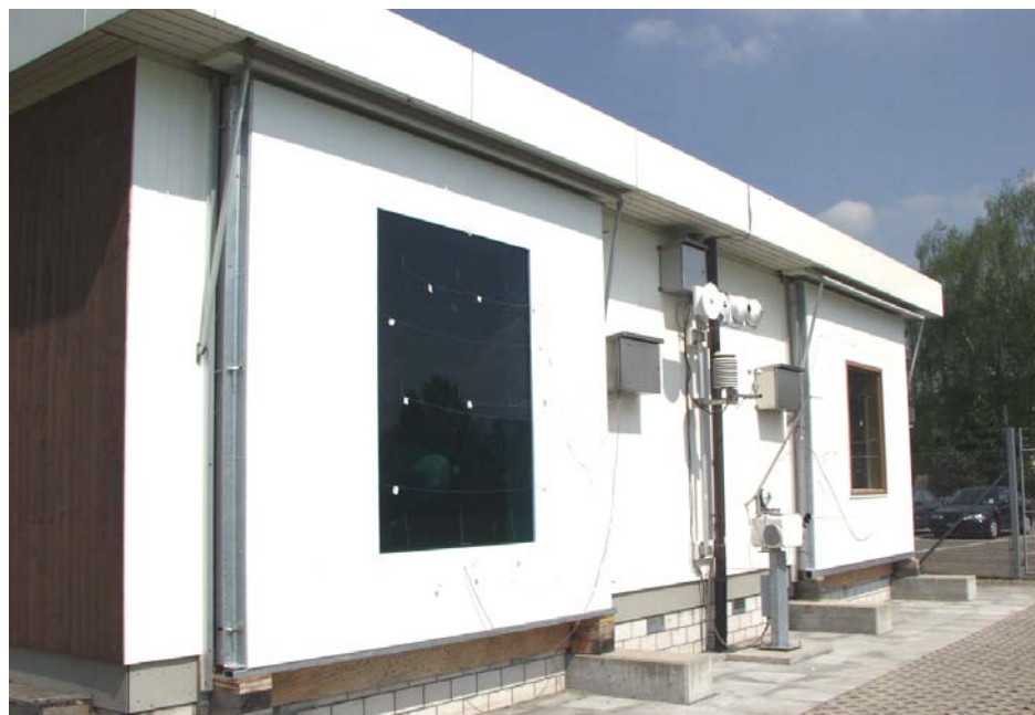
Fig. 1: Solarprüfstand der EMPA für die Untersuchung von solaren und thermischen Eigenschaften transparenter Fassadenbauteile. Zwischen den Testflächen ist die Messtechnik für die Klimadatenerfassung mit einem elektronisch nachgeführten Direktstrahlungssensor platziert.
