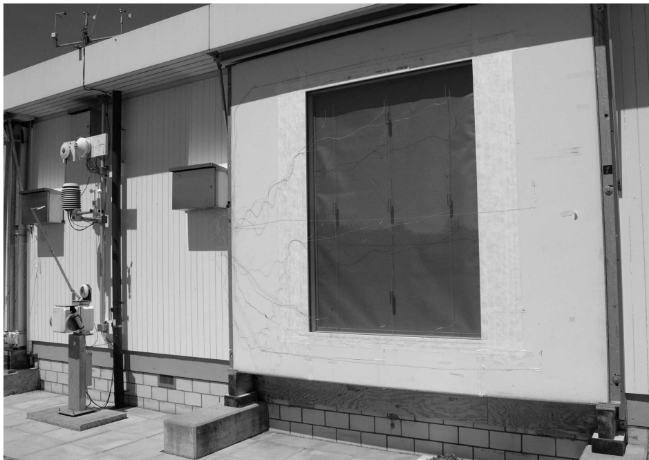
Fig. 1: Fassadenprüfstand auf dem EMPA-Areal für die Untersuchung der solaren und thermischen Eigenschaften von transparenten Fassadenbauteilen
