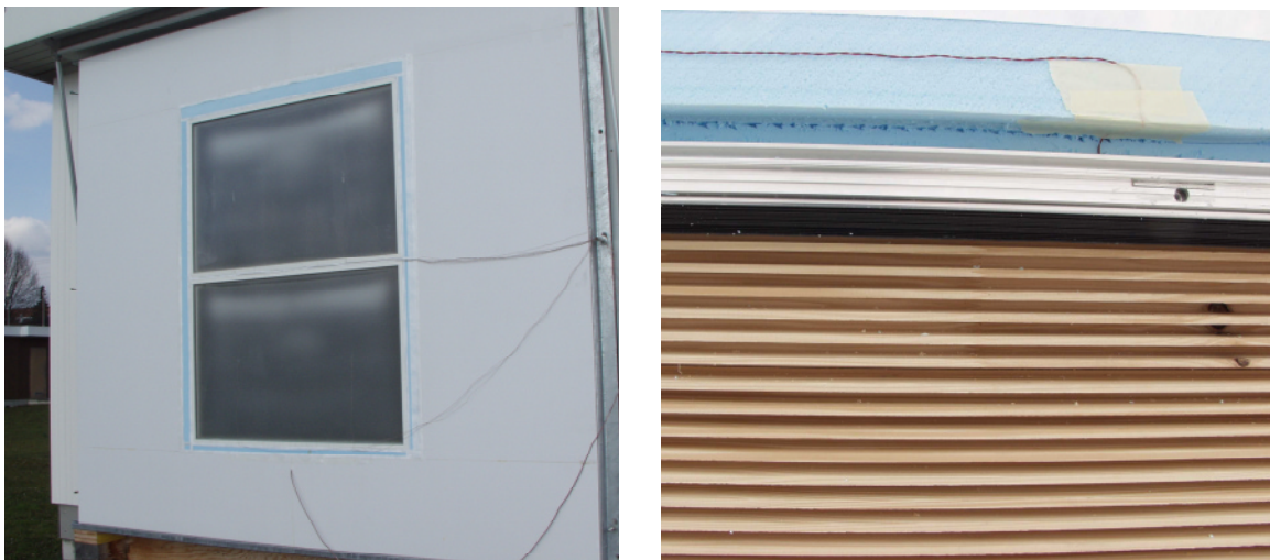
Fig. 5: TWD-Fassadenmodul SolFas (links) und Lucido -Holzlamellensystem (rechts) eingebaut im EMPA-Solarprüfstand.
