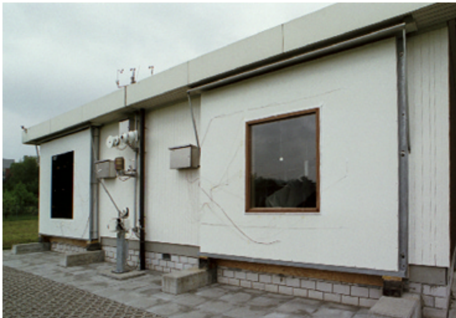
Fig. 1: Der EMPA-Solarprüfstand besteht aus zwei symmetrischen, räumlich getrennten Testzellen (hier mit Prüfraumen und eingebauten Testkomponenten). Dazwischen befindet sich die Aussenklimadatenerfassung mit dem Nachführsystem für die Direktstrahlungsmessung. Durchgeführte Arbeiten und erreichte Ergebnisse
