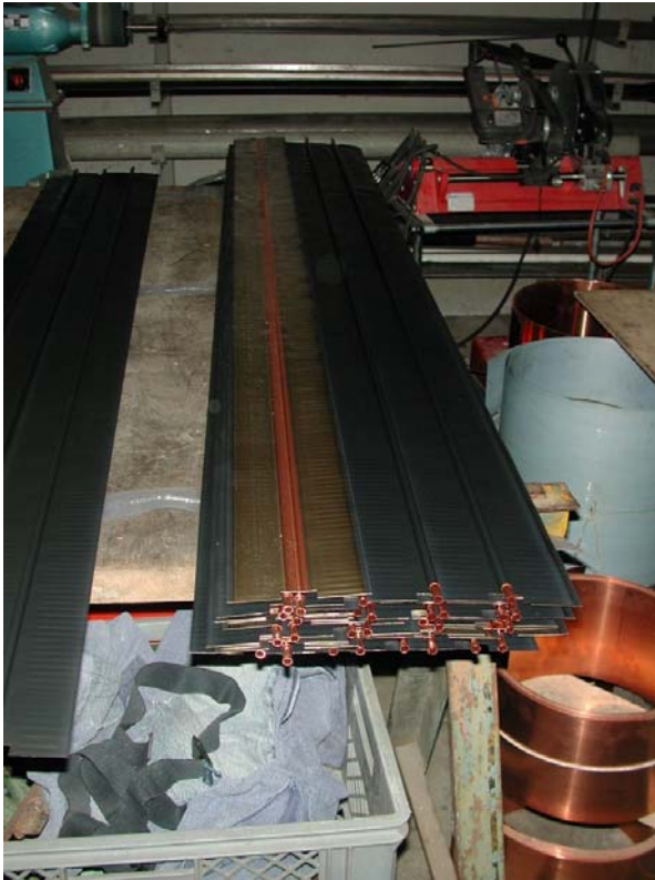
Abb. 3.5 Die Absorberfinnen vor der Verlötung mit dem Sammelrohr.
