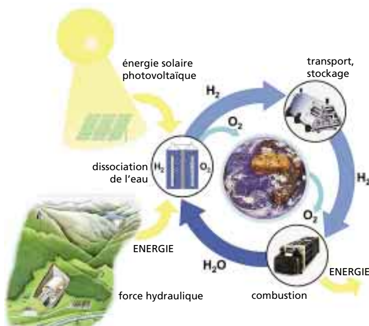
Le cycle de l'hydrogène avec sa production à partir de sources d'énergie renouvelables. (Graphique : Institut für erneuerbare Energie Schweiz, www.ifres.ch )
