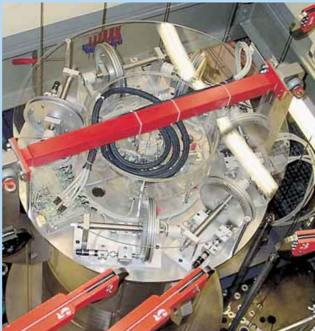
Le réacteur de recherche PROTEUS de PSI est utilisé pour étudier expérimentalement des échantillons de combustible.
