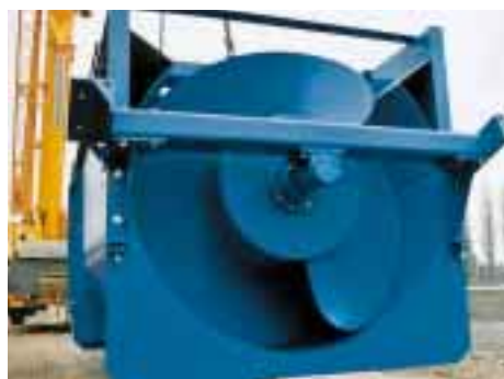
La vis hydraulique présente de nombreux avantages : rendement élevé, entretien minime, passage des poissons.
