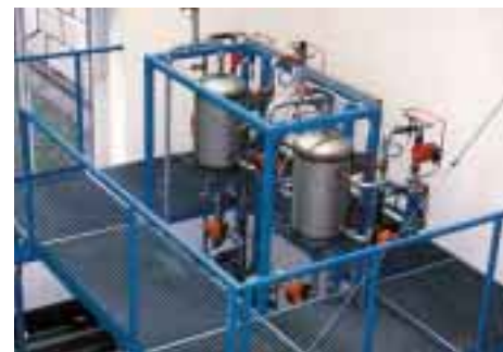
Banc d'essai pour pompes à chaleur saumure-eau à l'Institut des techniques de mesure et de régulation (IMRT) de l'EPF de Zurich. C'est ici qu'ont lieu les mesures destinées à comparer les stratégies de modulation de la durée des impulsions.
