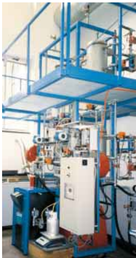
Banc d'essai pour pompes à chaleur saumure-eau à l'Institut des techniques de mesure et de régulation (IMRT) de l'EPF de Zurich. C'est ici qu'ont lieu les mesures destinées à comparer les stratégies de modulation de la durée des impulsions.
