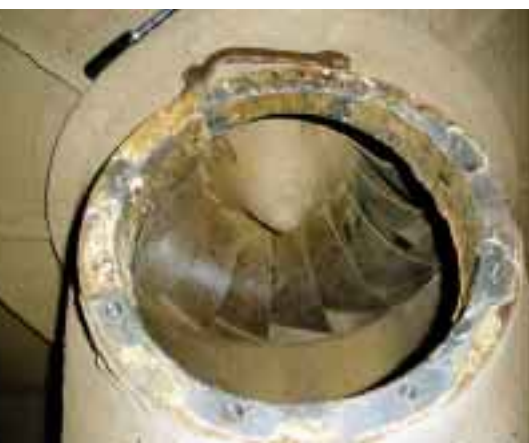
La turbine Francis à palier horizontal du moulin Högler avant sa rénovation. (Photos : Fondation Revita/EBL)
