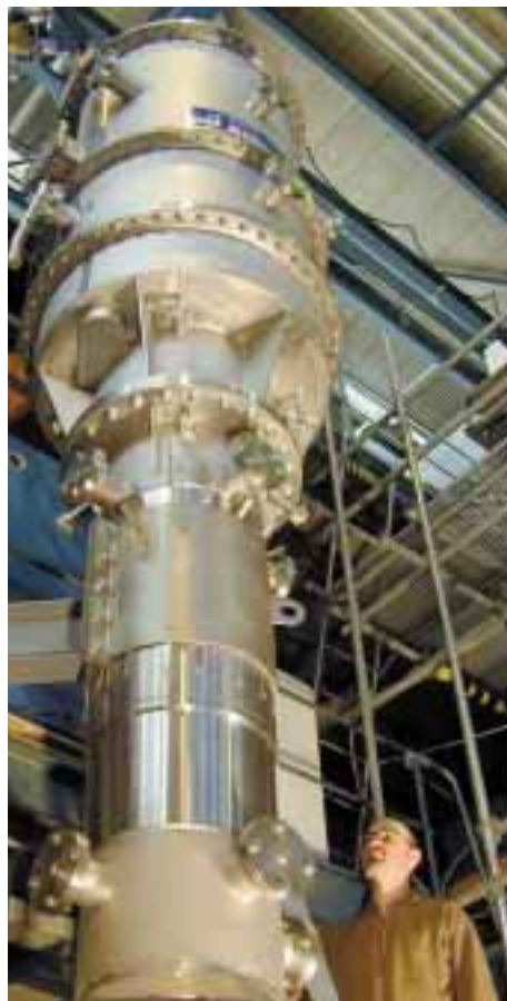
L'installation expérimentale ARTIST, modèle d'un générateur de vapeur avec son faisceau de tubes, le module séparateur d'eau et un module pare-gouttes.
